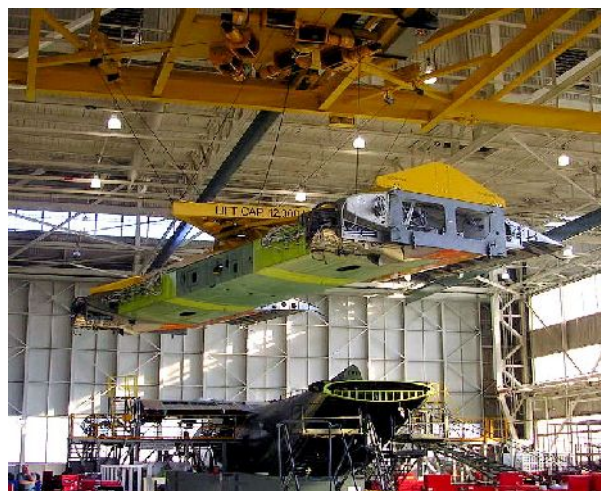
Рис. 8. Кабельный робот AMP для сборки крупногабаритных изделий позиционирует крыло самолета при сочленении с фюзеляжем
