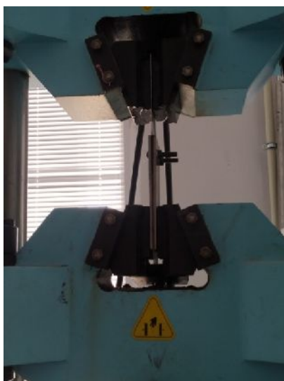
Рис. 4. Общий вид испытания образцов нахлесточных соединений
