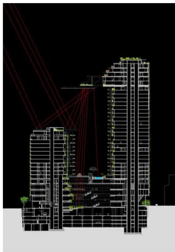
Рис. 8. Использование отражённого солнечного излучения в здании «One Central Park», г. Сидней (Австралия)
